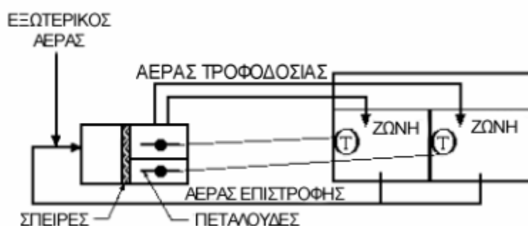
Σχήμα 11. Σχηματικό διάγραμμα ενός συστήματος πολλαπλών ζωνών.
