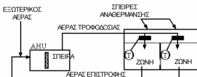
Σχήμα 10. Σχηματικό διάγραμμα ενός συστήματος τερματικής αναθέρμανσης.
